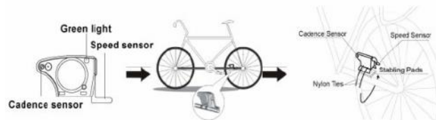
slika: senzor kadence, zelena lu ka, senzor hitrosti --- senzor kadence, najlonske vezice, blazinice za stabilizacijo.
